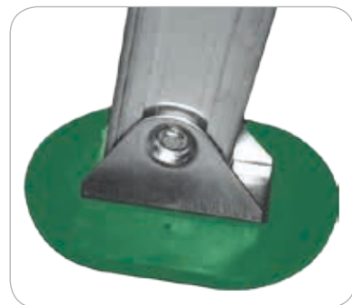
EN OPTION : Patin articulé ovale 16 x 11 cm en caoutchouc pour éviter l'enfoncement de l'échelle dans le sol
