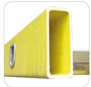
Aus Glasfasern und Gewebe-Harz beschichtetem Kompositprofil durch Pultrusionsverfahren hergestellt.
