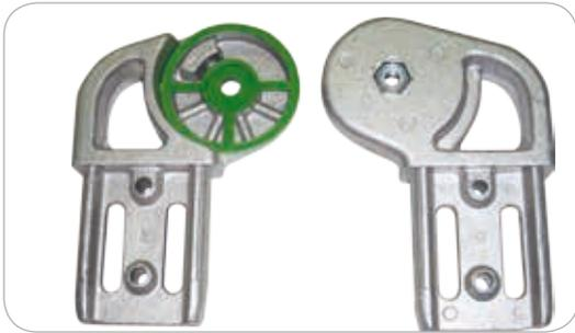
Articulation en fonte d'aluminium avec insert en polyamide pour réduire le grippage des matériaux
