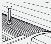
**B-** Con foro  $\varnothing$  12 mm al centro dello sbarco. Forare anche il piano di carico e bloccare con spina
