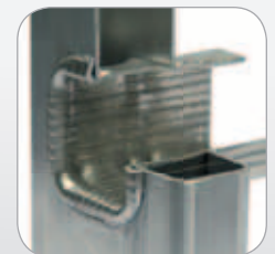
Liaison montant / échelon par double expansion et sertissage
