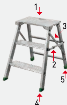
1- PEDANA IN FUSIONE DI ALLUMINIO 320x460 mm Cod. FU-131 2- COMPASSO ANTI CHIUSURA Cod. FE-271 3- TIRANTE LATERALE Cod. FE-175 4- PIEDE ANTERIORE 24x60 mm inclinato Cod. PL-398 5- PIEDE POSTERIORE 24x50 mm Cod. PL-015
