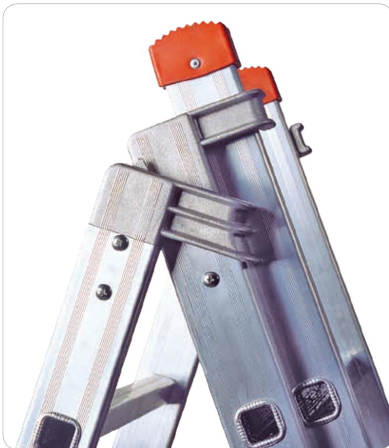
Cerniere ad alta resistenza in alluminio fuso fissate ai montanti con viti e non rivetti. Particolarmente facilitato l'uso sia a sfilo che in apertura a cavalletto grazie ai perni che roteano facilmente nelle asole delle fusioni di base.
