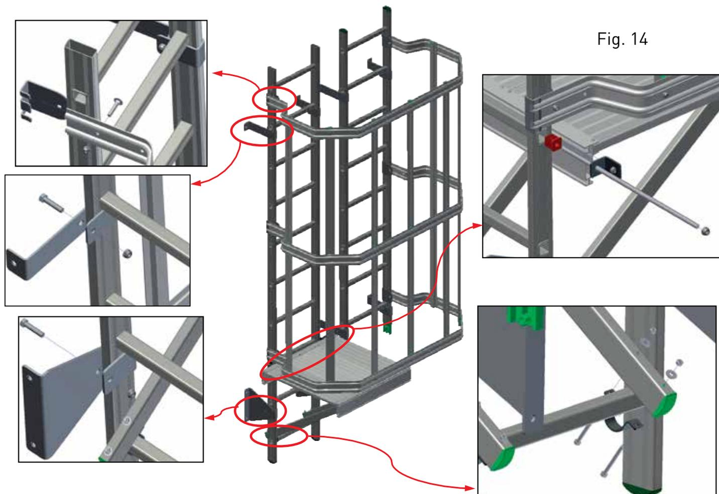
Après avoir assemblé les différents modules au sol, insérer du haut les modules complets de crinoline et patte de fixation et les fixer au mur.
