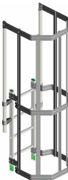
**Changement de volée:** il inclus 1 échelle h 2995 mm (sur laquelle le palier sera monté), 1 échelle h 2395 mm, crinoline double (réf. 2GA2026), palier de repos, patte de accrochage à l'échelle, jonctions en nylon, visserie, et 2 pattes grandes de fixation à mettre sous le palier (FE-170).
